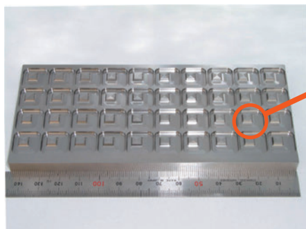
14mm 角 ポケット加工 Pocket Size : 14x14mm
