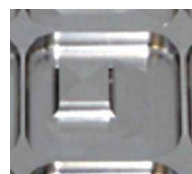
14mm 角 ポケット加工 Pocket Size : 14x14mm
